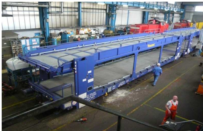
Fabrication d'un wagon porte-autos
